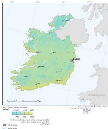
**FIGURE 6** - IRELAND GLOBAL IRRADIATION AND SOLAR ELECTRICITY POTENTIAL - OPTIMALLY-INCLINED PHOTOVOLTAIC MODULES (PHOTOVOLTAIC GEOGRAPHICAL INFORMATION SYSTEM (PVGIS), 2012).
